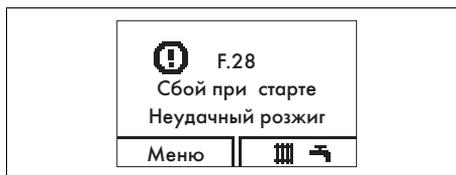
Если горелка не розжигается после пяти попыток розжига, изделие не запускается и переходит в режим неисправности. Об этом свидетельствует индикация на дисплее кода ошибки F.28 или F.29.
